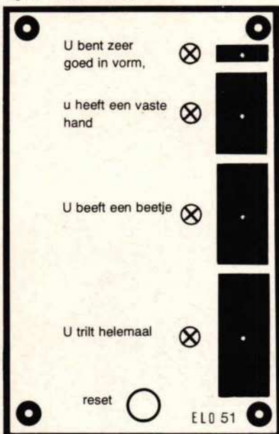
Fig 3. Print ELO 51 als frontplaat voor de nervusiteitsdetector.
