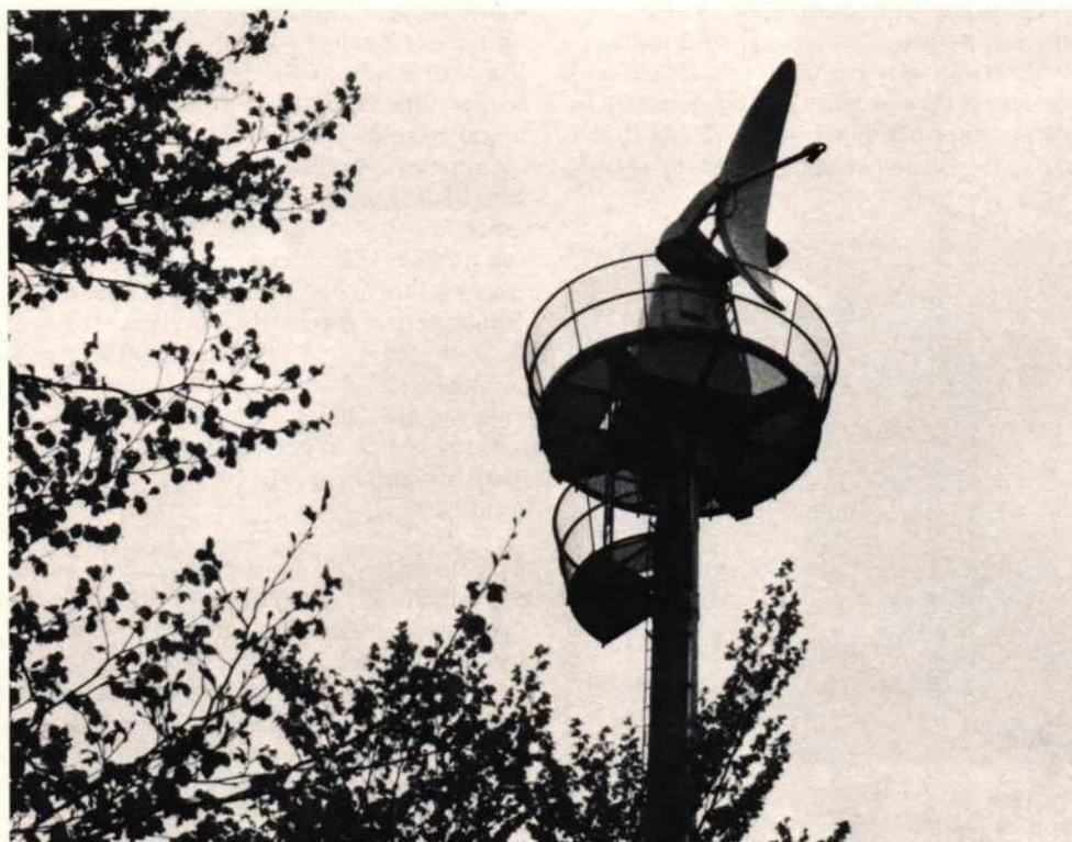
Afb. 13. De radarantenne vervolgt de reflectie van de radio-sonde die uit staniol bestaat.
